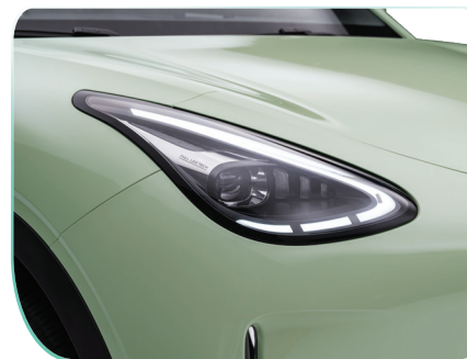
Đèn pha LED với công nghệ chiếu sáng thích ứng giúp chiếu sáng đường đi lên tới 170 mét phía trước và rộng 22 mét.
